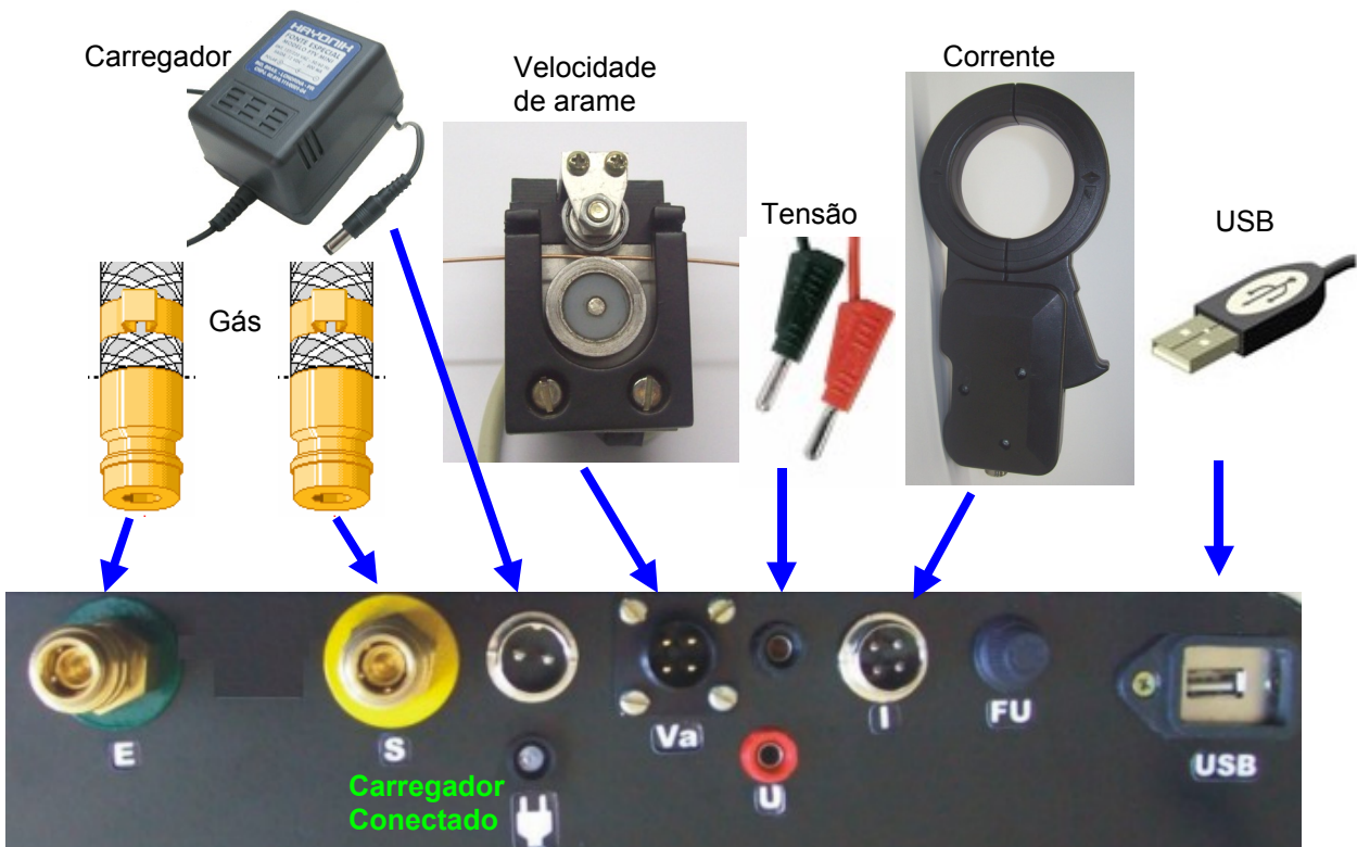
Figura 21 – Painel de conexões .
